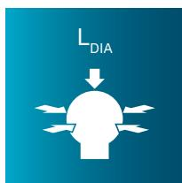
Значение  $L_{DIA}$  представляет собой максимально допустимую погрешность при различных положениях манипулятора. Поэтому оно характеризует повторяемость результатов измерений манипулятора.
