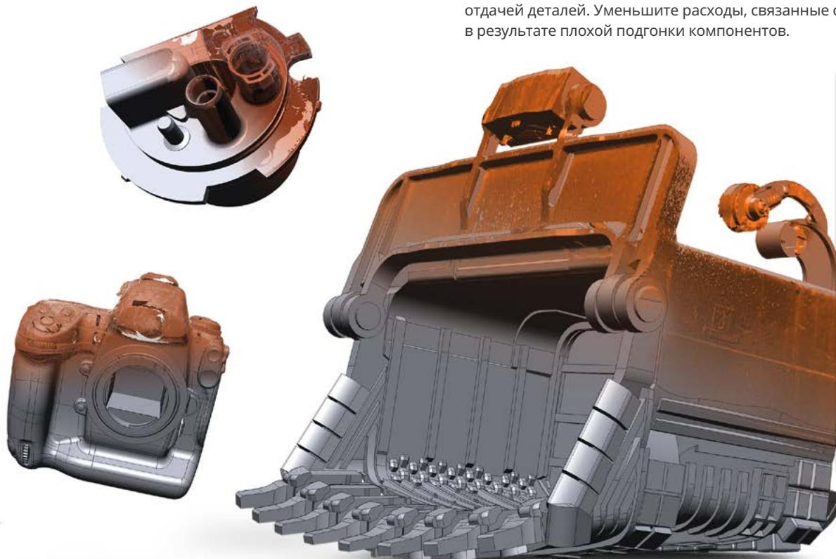
Параметрические модели твердых тел, созданные в **Geomagic Design X**
