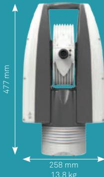
\*Все значения погрешности указываются как максимально допустимая ошибка (MPE) и вычисляются согласно стандартам ASME B89.4.19-2006 и ISO 10360-10:2016 с использованием прецизионных 1,5-дюймовых отражателей Leica с красным ободком на расстоянии до 60 м, если не указано иного.
